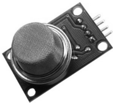
图 3-1-4 MQ-2 烟雾气敏传感器
