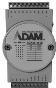
图 3-1-10 ADAM-4150 数字量采集控制器
